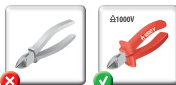
Для работы под напряжением используйте изолированный инструмент с рукоятками, имеющими маркировку  $\Delta$  1000 В и сертифицированный по стандарту VDE. Обычные рукоятки, выполненные из полимерно-резиновых композитов, не являются гарантией защиты от поражения электрическим током.
